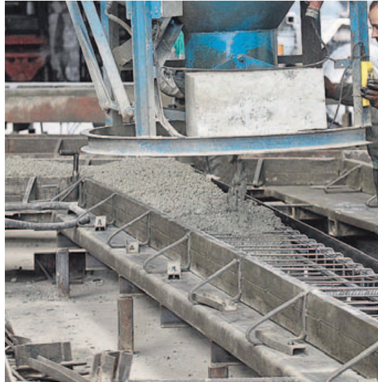
Dos ejemplos de construcción integrada. A la izquierda, relleno de cemento en estructuras de acero; a la derecha, vigas ensambladas. FOTO A. L.
