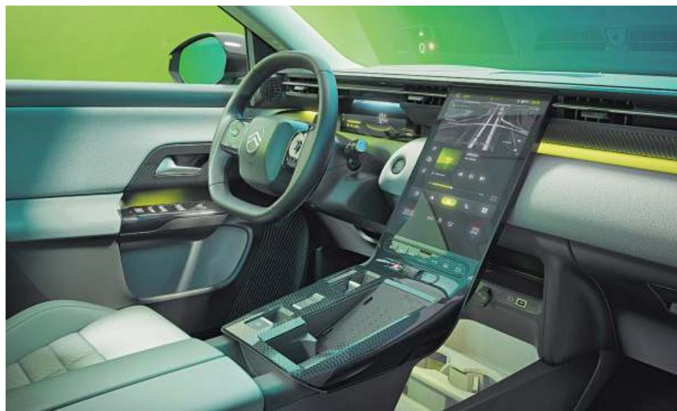
**INTERIOR DIGITAL.** Pantalla central y pantalla tras el volante achatado se conjugan ahora con la posibilidad de leer toda la información en el parabrisas, gracias al sistema de proyección, y cargar el móvil de forma inalámbrica.
