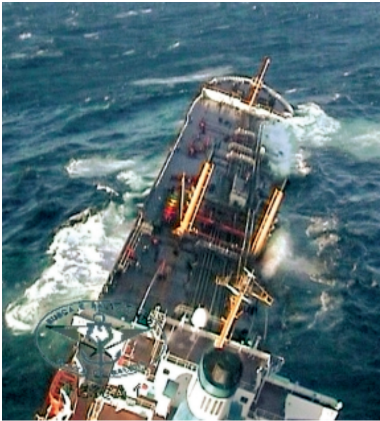
El buque se escoró unos 45 grados tras sufrir una vía de agua a causa del oleaje
