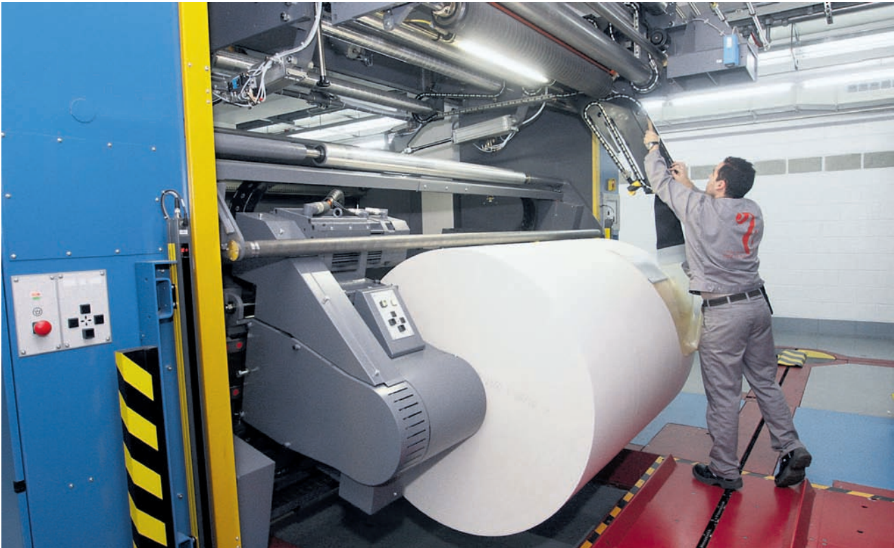
La incorporación de bobinas de papel se automatiza con el nuevo sistema editorial. Es el primer paso en todo un proceso que se inicia poco antes de la medianoche y en el que trabajan más de 60 personas
