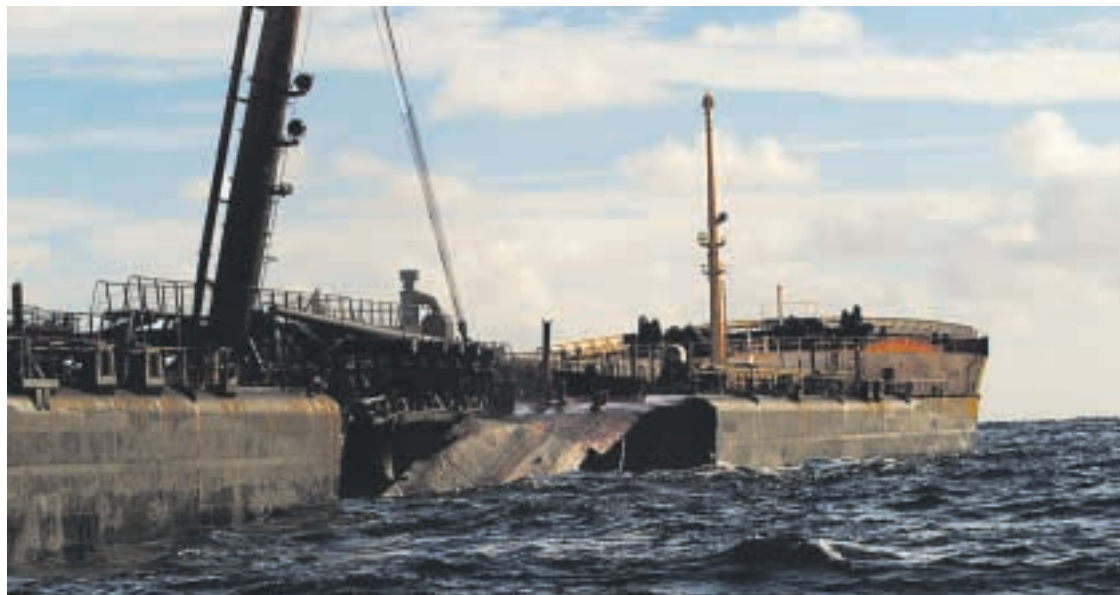
IMÁGENES INÉDITAS DEL BUQUE TOMADAS POR LA ARMADA. Unas fotos obtenidas desde la fragata «Balears» muestran los daños estructurales que presentaba el petrolero por estribor 24 horas antes de que se partiese en dos a 220 kilómetros al oeste de la costa gallega
